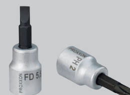
3/8" hlavica zástrčná PHILLIPS, 50 mm (PH). Bit vyrobený z vysoko ušľachtilej ocele s prídavkom kremíka, mangánu a molybdénu. Hlavice z CrV ocele.
