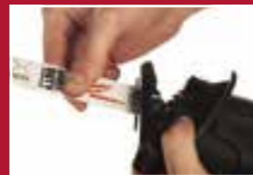
FIXTEC™ upínanie a nastaviteľná oporná päťka
